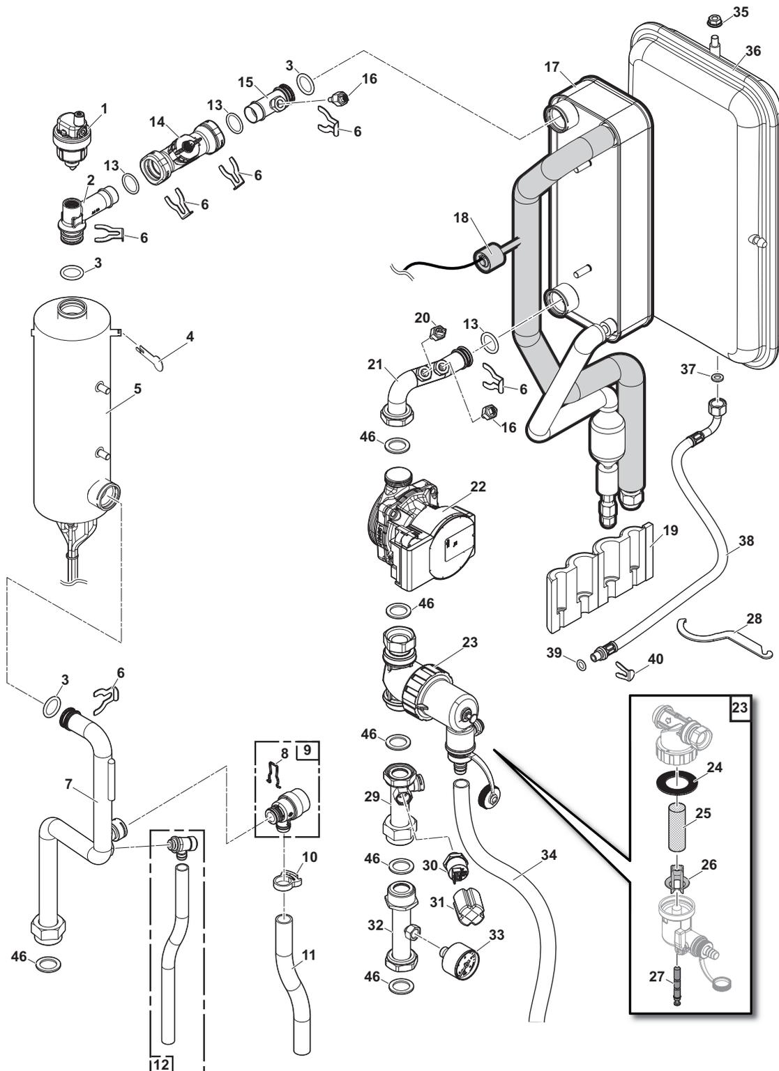
**Mercuria ACE - Circuito idraulico con resistenza**
