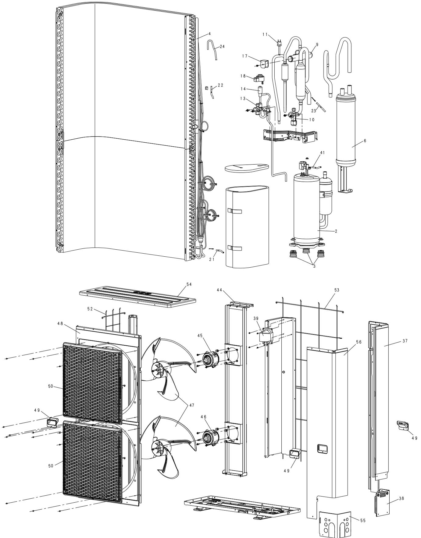
Unità esterna per pompa di calore monofase 12M - 15M
